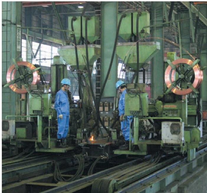
BOX角溶接機「ウェルスター」 (中央工場)
