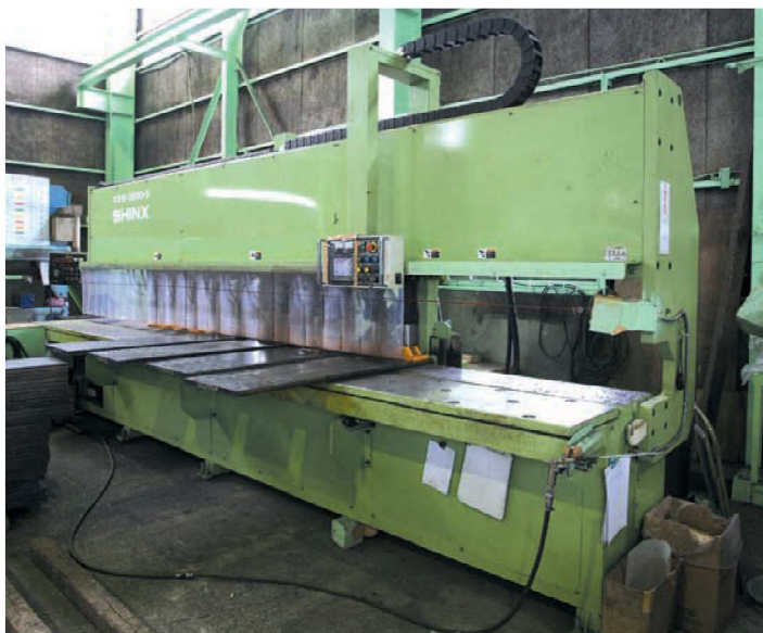
プレート開先加工機「VXW-3000」 (東工場)
